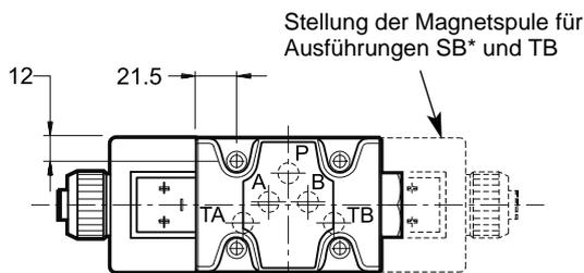
Befestigungsschrauben: 4 Zylinderschrauben mit Innensechskant ISO 4762 M6x40
