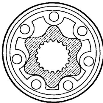
Ausführung mit Stator-Innenverzahnung. Ideal für den Dauerbetrieb bei mittleren Betriebsdrücken.
