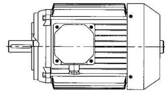
Bauform B3/B14 A mit Fußflansch.
