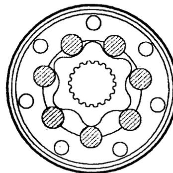
Durch die hydrodynamisch gelagerten Rollen werden die Reibungsverluste auf ein Minimum reduziert. Somit wird eine längere Lebensdauer bei hohen Leistungen und hohen Drücken gesichert.
