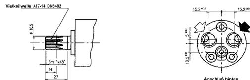
**Motor mit zylindrischer Welle – Ölanschluss seitlich**
