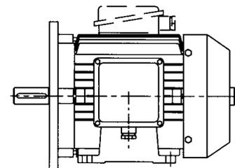
Bauform B3/B5 mit Fußflansch.
