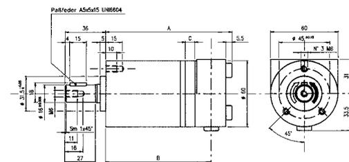
**Motor mit Zahnwelle – Ölanschluss seitlich**
