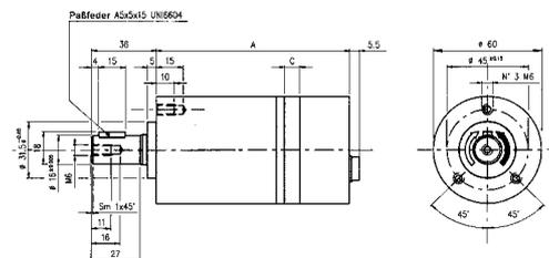
**Motor mit Zahnwelle – Ölanschluss hinten**
