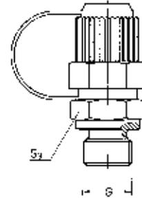
Einschraubgewinde: Whitworth-Gewinde, zylindrisch - Einschraubzapfen mit Dichtung
