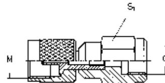
**Gerade Verschraubung mit Schraubkupplung M16**
